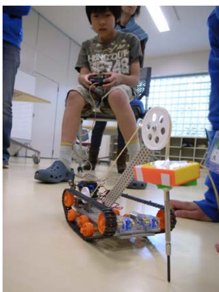
写真8 リフト機能を取り付けたローバー
